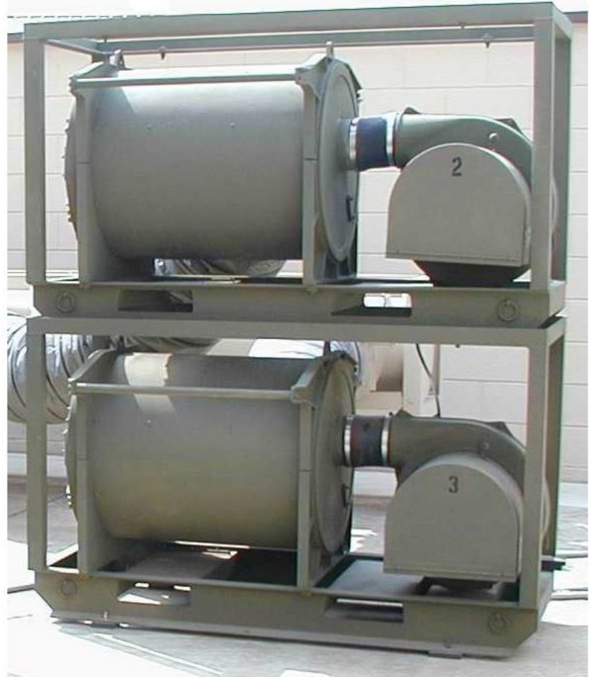
Fan-Filter Assemblies (FFAs)
